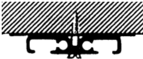
Stropna montaža 1 vod.
